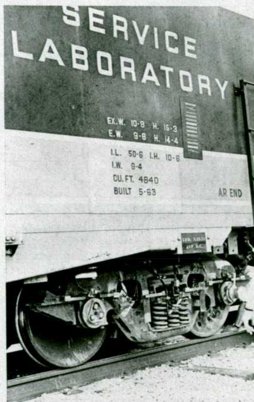
Bogie Diamond, para mercancías, construido por la Cast Steel Co., sometido a ensayos de estabilidad en las vías de experimentación de Pueblo (Colorado). El bogie está provisto de un eje dinamométrico, que se ve en segundo término.
