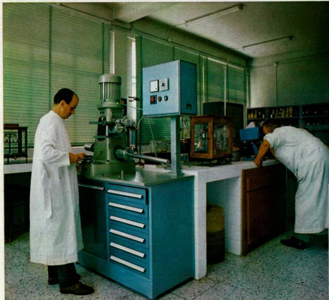
Lubricantes. Ensayo de cuatro bolas.
