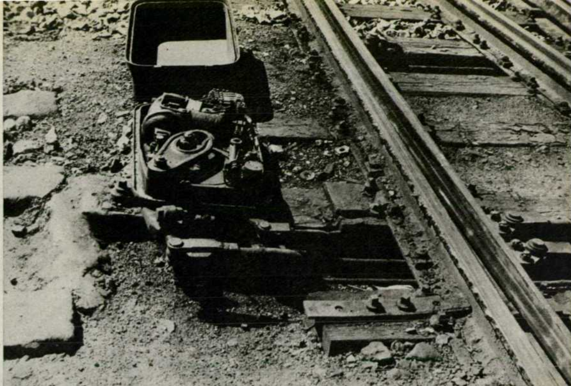
Motor de aguja del enclavamiento eléctrico Thomson-Houston.
