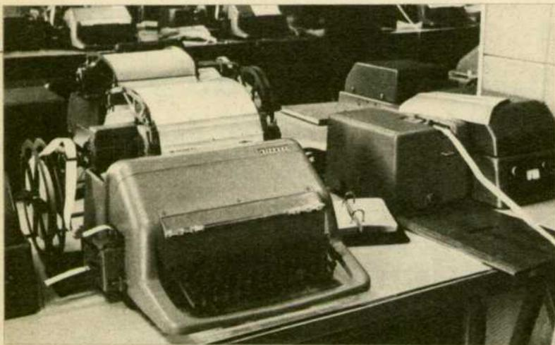
Teletipo con perforador de cinta y transmisor automático.
