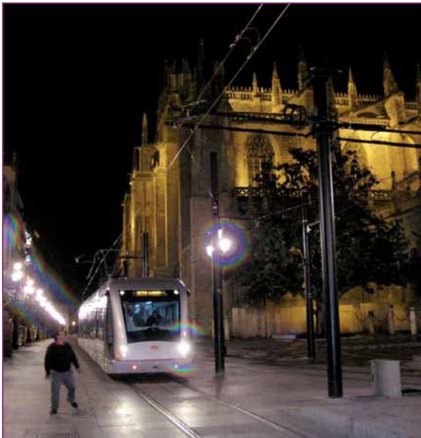
Este Mitrac dispone de condensadores y acumuladores que almacenan la energía liberada en el frenado y la devuelve al equipo de potencia durante los procesos de aceleración.
